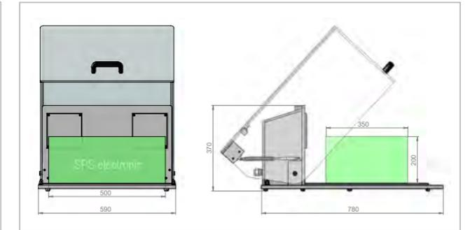
Einfache Prüfhaube mit schwenkbarer Acrylglashaube für geringe Stückzahlen und Prüflinge mit leichtem Gewicht.
