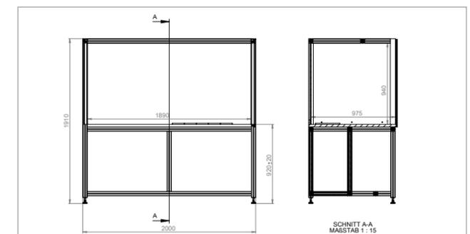
Prüfkäfig PK 6000A mit Lichtvorhang und versetztem Fußraum
