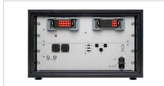
Stoßspannungsprüfgerät ST 4000B
