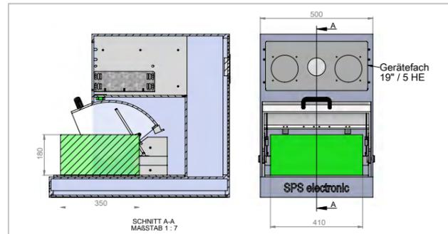
Einfache Prüfhaube mit schwenkbarer Acrylglashaube für geringe Stückzahlen und Prüflinge mit leichtem Gewicht.
