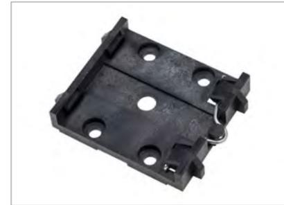
Um die korrekte Montage der SPS electronic Hochspannungsrelais zu gewährleisten wurde der Montageclip MC 22 entwickelt. Der aus robustem Kunststoff gefertigte Montageclip garantiert eine einfache und platzsparende Befestigung der Hochspannungsrelais RL 21, RL 42 und RL 42-L auf einer 35 mm Hutschiene. Für eventuell anfallende Wartungsarbeiten können die Montageclips ebenso einfach demontiert werden.
